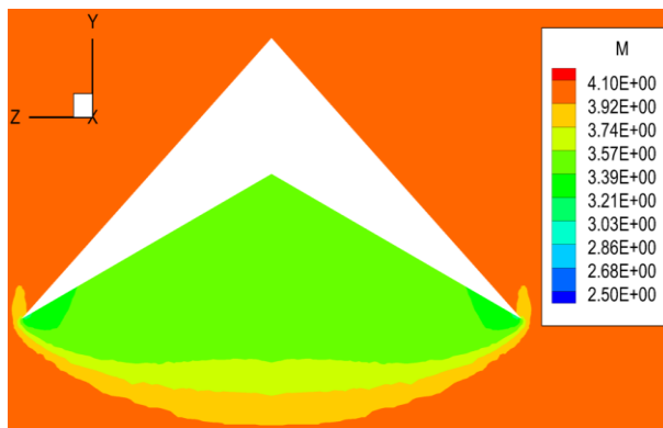
Рис. 51. Конфигурация ударной волны в плоскости поперечного сечения \Lambda -волнолета на расстоянии s = 0.9l от передней критической точки для нерасчетного режима обтекания M_\infty = 4
