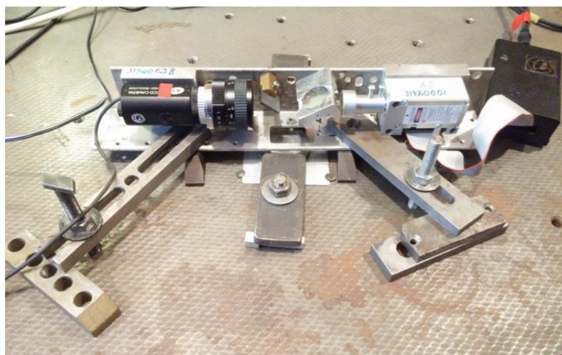
Рис. 5.2.1 – Исследование экспериментального образца с помощью спекл-интерферометрической установки
