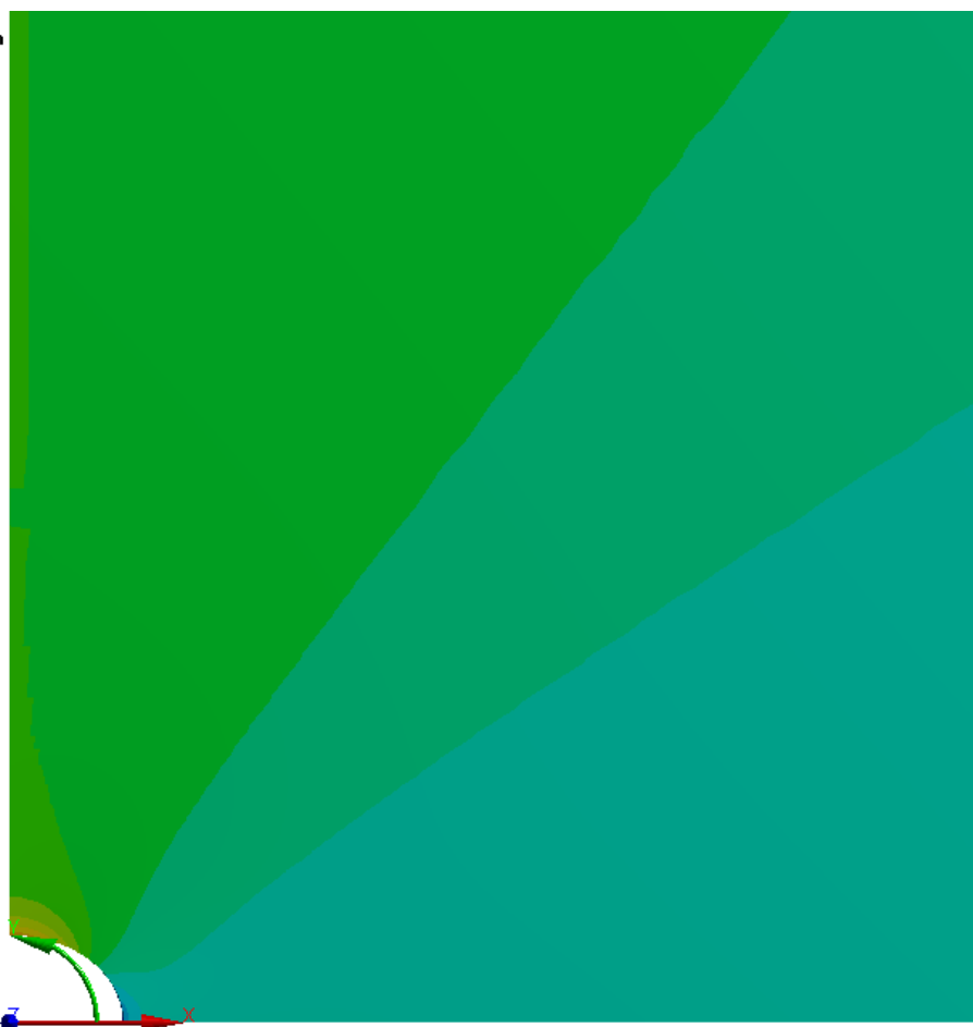
б) – Распределение окружного напряжения, \sigma_{\theta}
