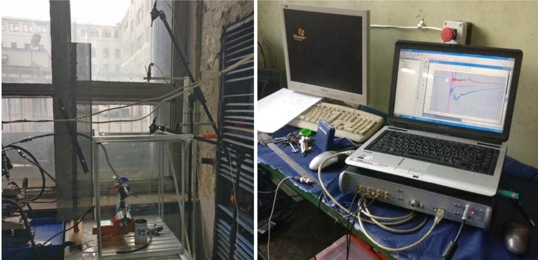
*Рис. 1. Экспериментальная установка для исследования впрыскивания жидкости*
