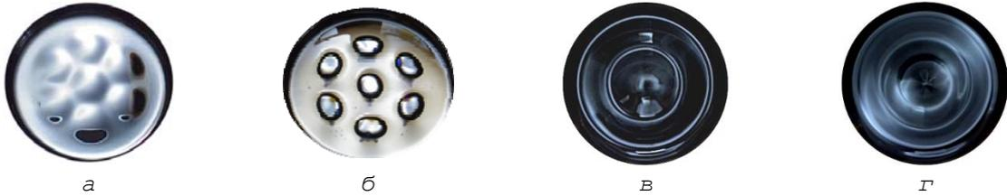
Рис. 1. Свободная поверхность слоя феррожидкости на жидкой подложке при амплитуде напряженности магнитного поля  $H_m = 0,9 H_c$  и частоте  $\nu = 0$  Гц (а);  $H_m = H_c$ ,  $\nu = 0$  Гц (б);  $H_m = 2 H_c$ ,  $\nu = 5$  Гц (в);  $H_m = 1,8 H_c$ ,  $\nu = 7$  Гц (г). Диаметр кюветы 59.0 мм; толщина слоя феррожидкости  $h = 3.3$  мм
