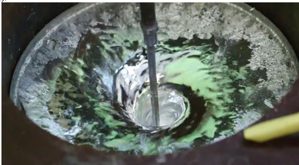
Рис. 1. Возникновение каверны вокруг электрода при электромагнитном вращении жидкого металла.
