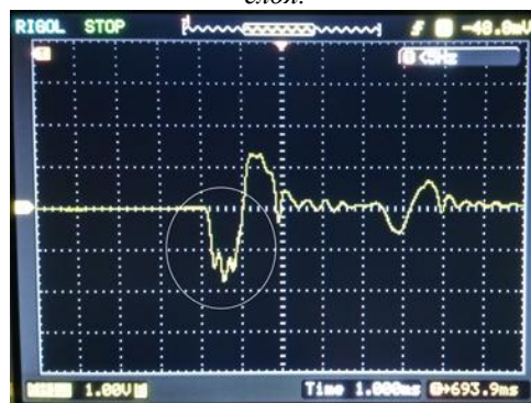
Рис. 5. Экспериментальная временная диаграмма ускорений центра масс шара при ударе. Окружность выделяет область сравнения с теоретической моделью.
