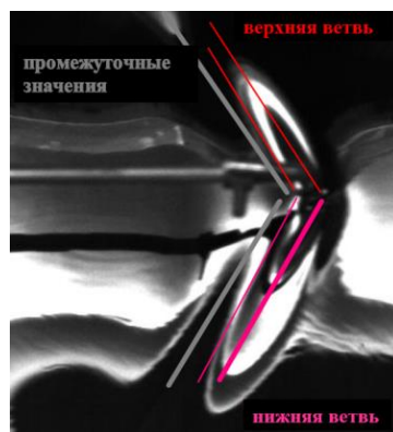
Рис.2. Схема определения углов наклона волновых валов.
