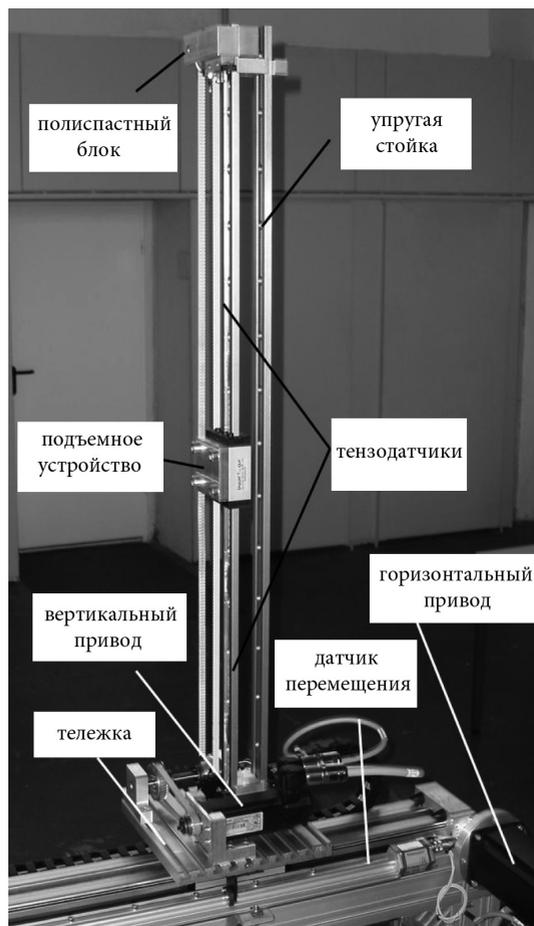
Рис. 5.2.1. Лабораторная установка.
