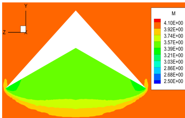
Рис. 13. Конфигурация ударной волны в плоскости поперечного сечения \Delta -волнолета на расстоянии s = 0.9l от передней критической точки для нерасчетного режима обтекания M_\infty = 4
