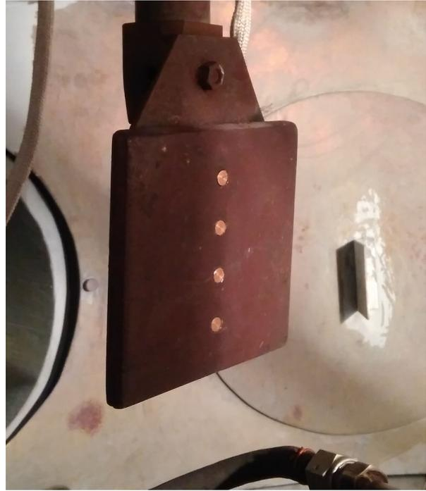
Рис. 4 — Модель-пластина для измерения тепловых потоков в установке ВГУ-4
