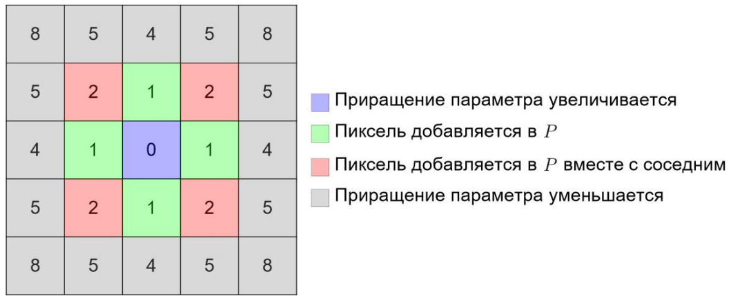
Рисунок 3.12 – Схема включения пикселей
